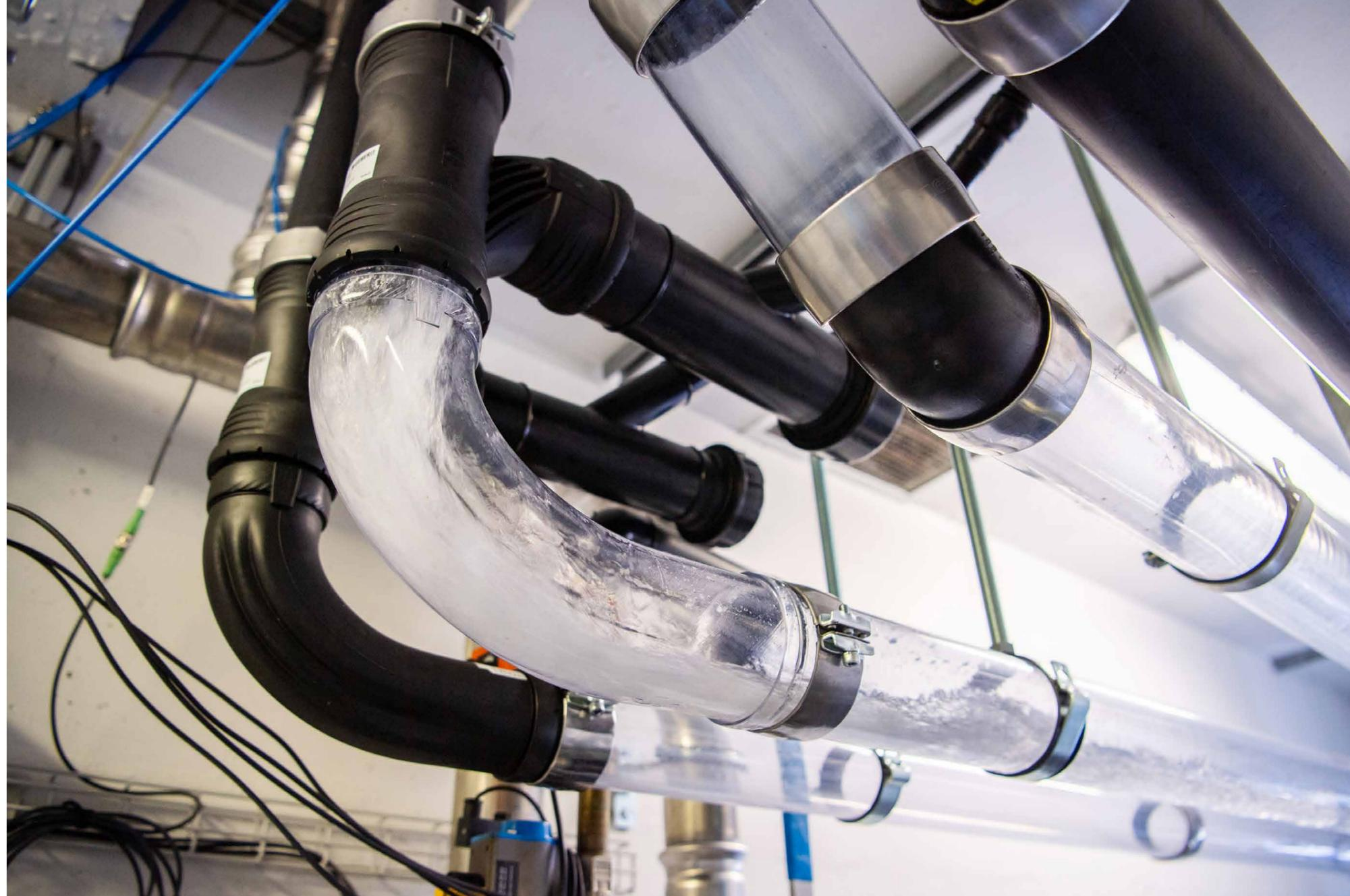
Il test effettuato con raccordi trasparenti forniscono importanti indicazioni sull'effettivo comportamento del fluido all'interno delle tubazioni.
