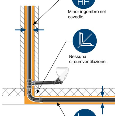
Nessuna pendenza nei collettori orizzontali fino a 6m\*, nessuna circumventilazione e la possibilità di collegare direttamente gli apparecchi al piede della colonna significano maggior libertà nella progettazione e semplicità d'installazione.
